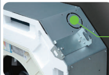
Подмес свежего воздуха должен составлять не более 20% от номинального расхода воздуха
